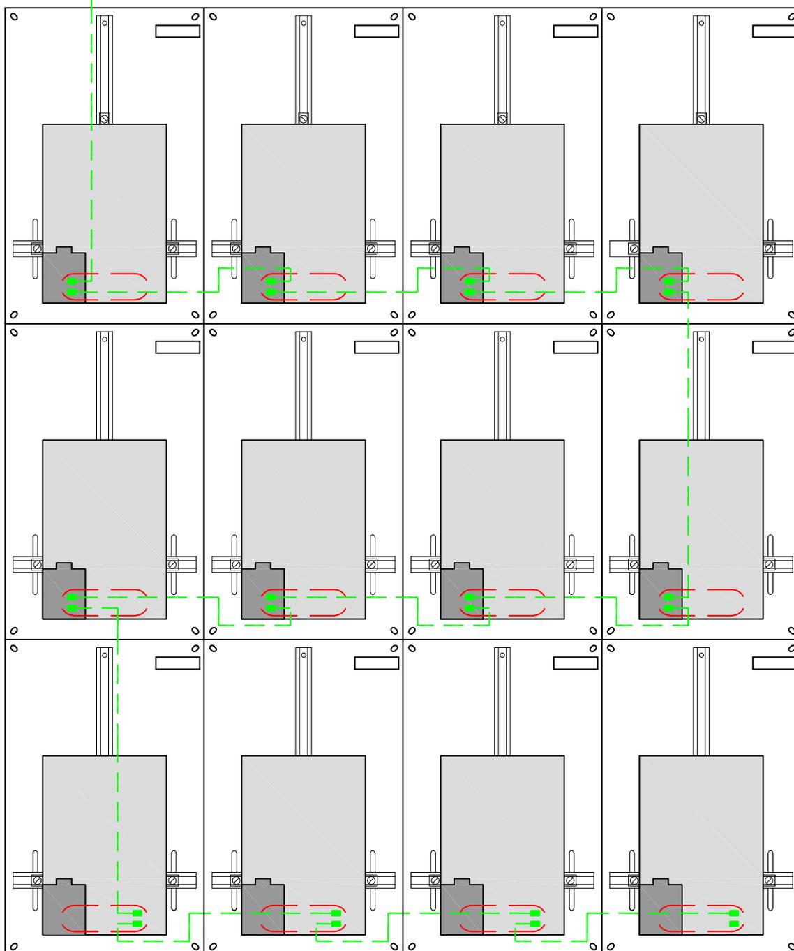
Principe d'exécution des liaisons de communication (chaînage) entre panneaux normalisés pour compteurs SIG :
