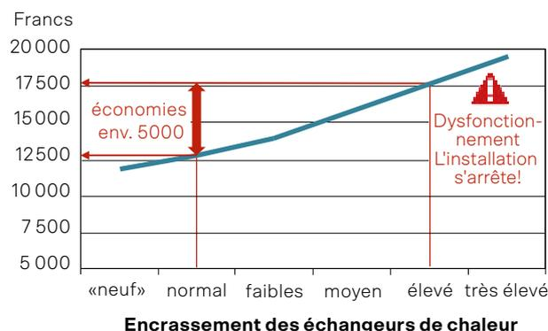
Coûts énergétiques annuels d'une installation d'une puissance (d'évaporation) de 210 kW avec des échangeurs de chaleur plus ou moins encrassés.
